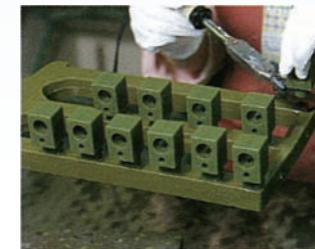
ワックス模型をランナーに接着し、ツリーを組み立てます。
