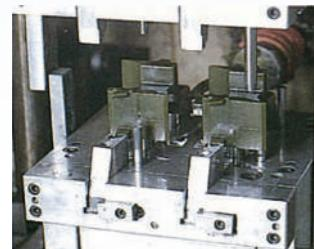
射出成型機により金型へワックスを注入し、ワックス模型を製造します。
